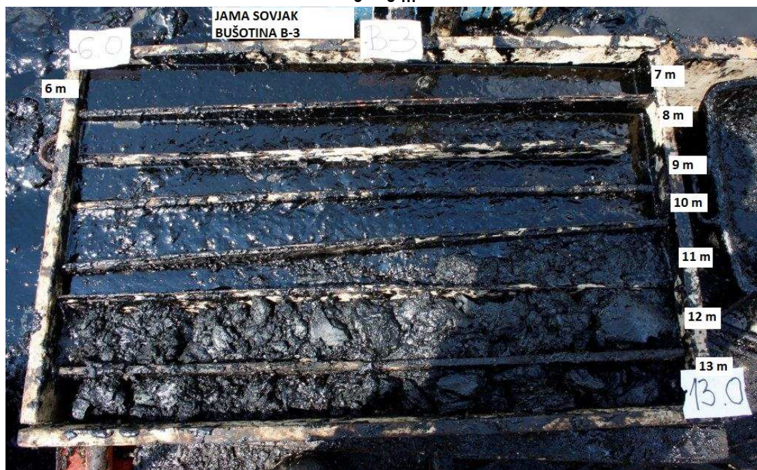
Slika 7. Uzorci izbušeni na položaju bušotine B-3
