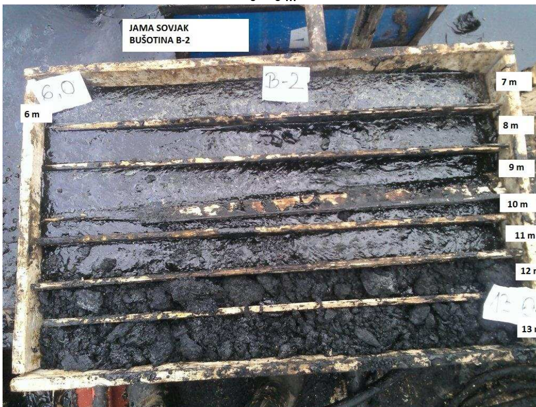
Slika 6. Uzorci izbušeni na položaju bušotine B-2
