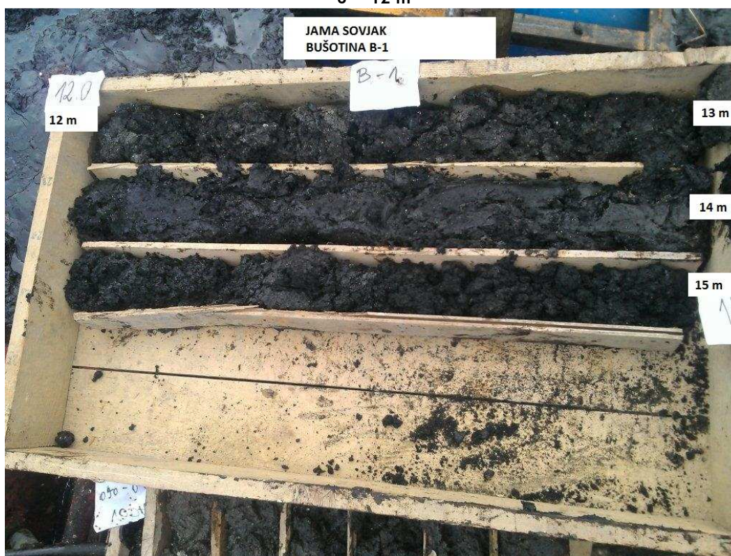
Slika 5. Uzorci izbušeni na položaju bušotine B-1
